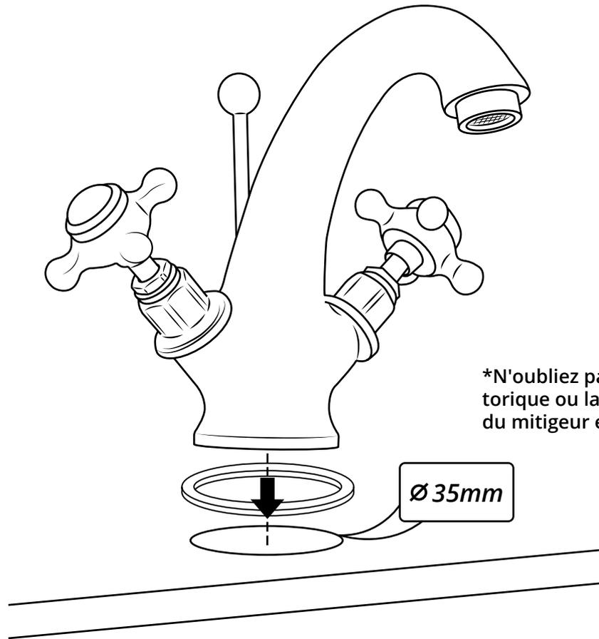
\*N'oubliez pas d'installer le joint torique ou la rondelle entre le corps du mitigeur et l'appareil sanitaire\*
