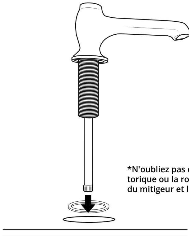
\*N'oubliez pas d'installer le joint torique ou la rondelle entre le corps du mitigeur et l'appareil sanitaire\*
