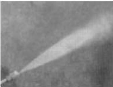
**15° Jaune** : La buse délivre un jet puissant avec un angle de 15°. Ne doit être utilisé que sur des surfaces résistantes.
