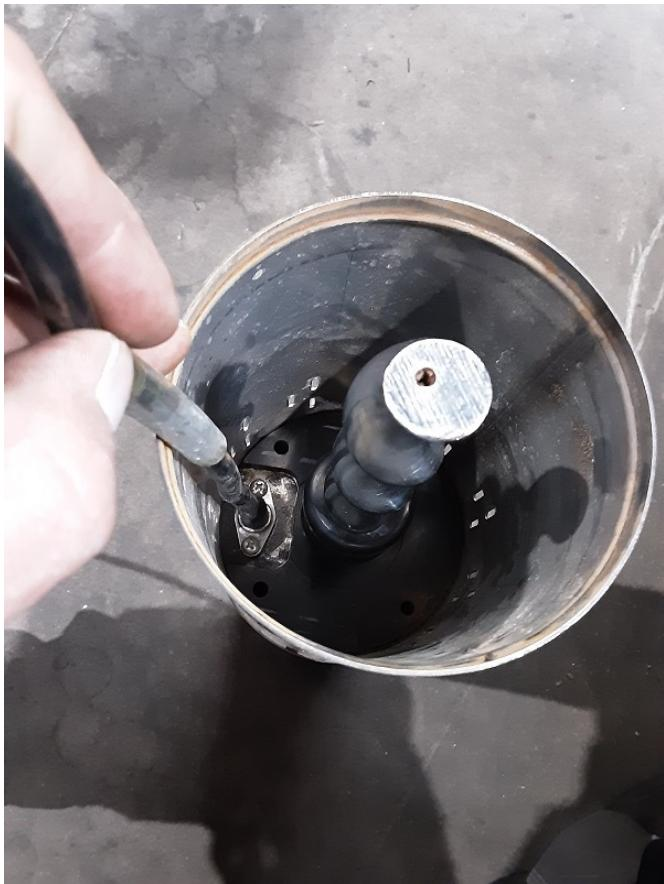
12/ Replacer la plaque de maintien (Attention à placer le câblage en face de la sortie de pompe).
