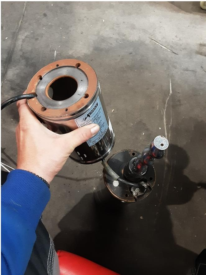
8/ TSSM4-80-1.8: Desserrer les filets de dumper de connexion du colimaçon (filet droit).
