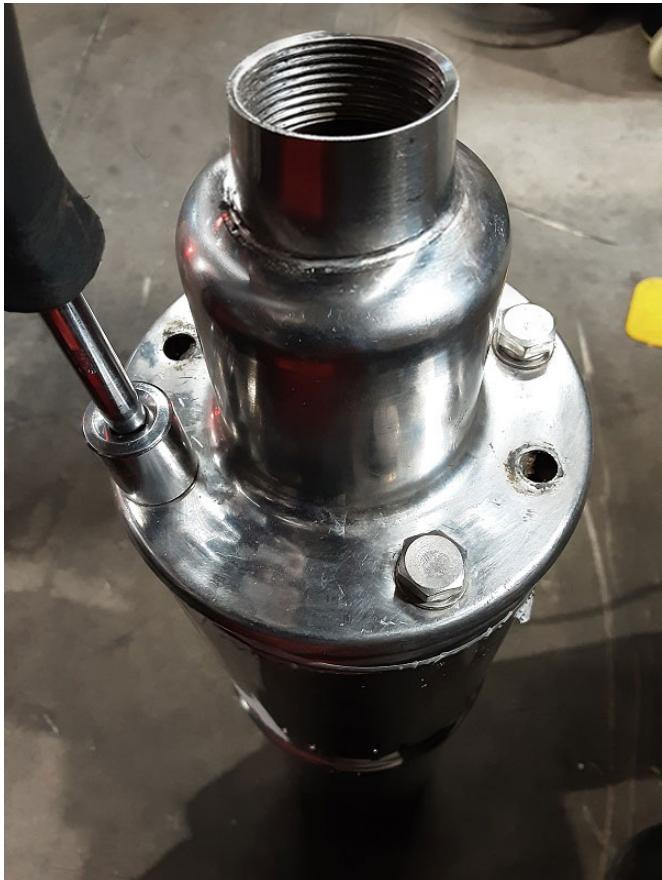
16/ Pour vous aider à remplacer les vis de fixation du corps de pompe repérer les vis du moteur. Ceci vous permettra de trouver les filets plus facilement.
