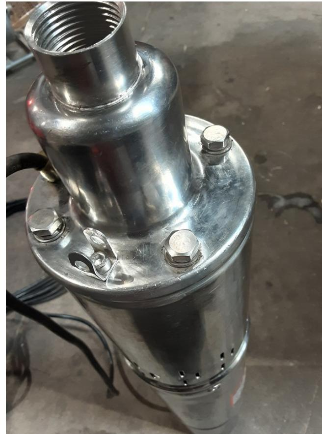
19/ Tester le produit (Ne pas utiliser la pompe sans eau ce qui provoquerait une surchauffe du colimaçon).
