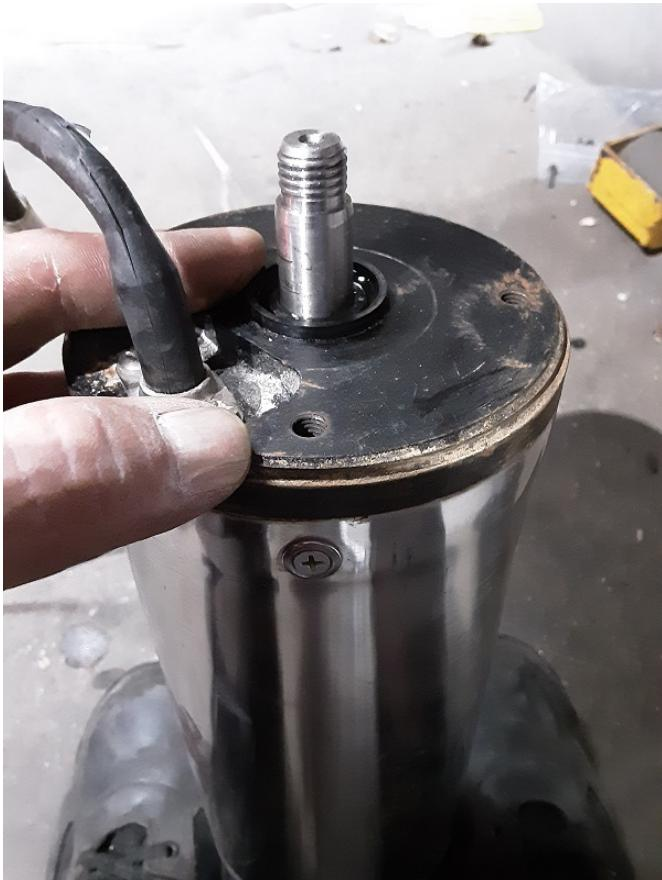
10/ Replacer le nouveau dumper et le colimaçon (un serrage à la main suffit).
