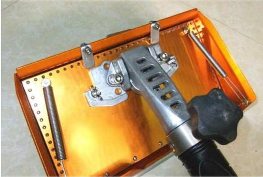
Réglez la tension sur le support de lame pour qu'elle corresponde à la quantité de plâtre de jointoiement qui doit être utilisé par la machine.
