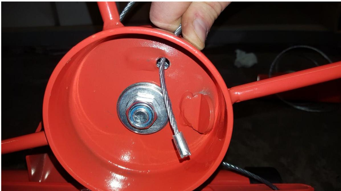
11) Passez le câble dans l'orifice du centre de la roue de réglage.
