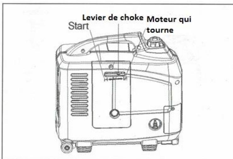
Un moteur chaud ne démarrera pas s'il y a trop de carburant dans le cylindre. Si cela arrive, attendez 5 à 10min avant de réessayer. Placer le levier du choke totalement vers la droite et le moteur devrait démarrer.
