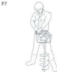
**Achtung: Halten Sie den Bohrer von allen Objekten fern sobald der Motor läuft. Wenn der Motor gestartet wurde, nehmen Sie langsam den Choke heraus und lösen Sie den Gashebel. Wenn der Motor trotz mehreren Versuchen nicht startet, kann der Motor überflutet werden. In diesem Fall entfernen Sie die Zündkerze und trocknen Sie diese. Wieder einsetzen und ohne Choke erneut starten.**
