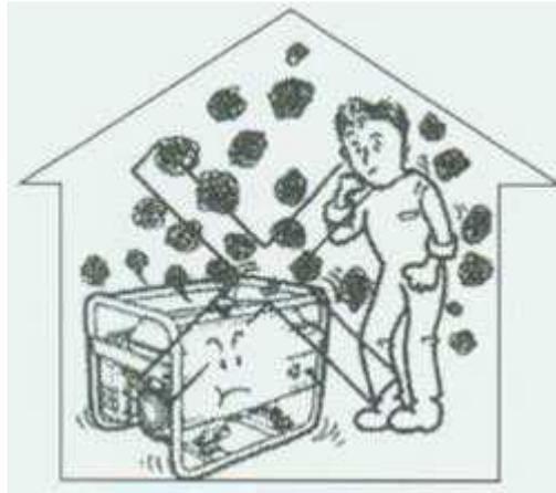
Verwenden Sie den Generator in einem gut belüfteten Ort. Dies vermindert die Gefahr einer Vergiftung mit Kohlenmonoxid.
