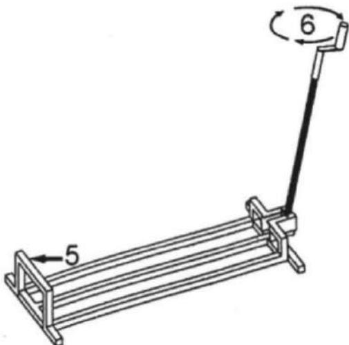
Falls der Mäher schief gehoben wird, drehen Sie die Kurbel gegen den Uhrzeigersinn, um den Mäher wieder auf den Boden zu stellen. Positionieren Sie den Mäher dann korrekt und beginnen Sie erneut mit dem Hebevorgang.
