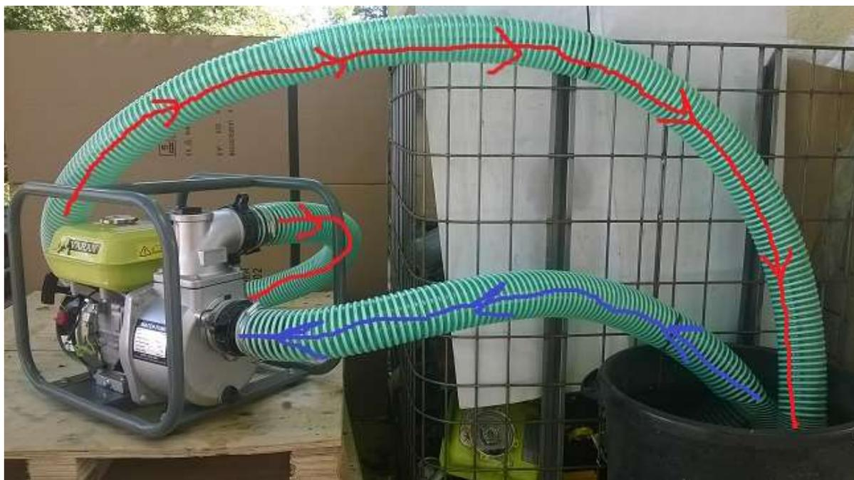
Per adescare la pompa, prevedere un tubo rigido in ingresso (senza tubo!) e un tubo in uscita. Collegarli correttamente e saldamente per evitare l'ingresso di aria.
