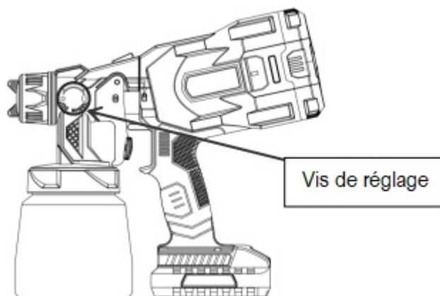
8) Réglage de la longueur du jet : Tournez ce bouton pour régler la forme ronde de la verticale à l'horizontale.
