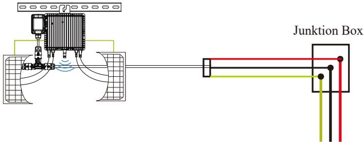
Schritt 5 - Anschließen des Microinverters an die PV-Module
