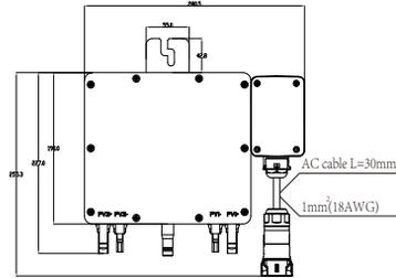
Das AC-Kabel am Mikro-Wechselrichter ist ein TC-ER-Kabel mit einem Kabelquerschnitt von 1 mm<sup>2</sup>(18AWG).
