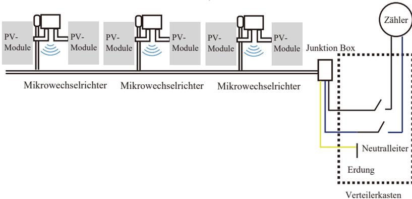
**ACHTUNG:** Der Farbcode der Verdrahtung kann je nach den örtlichen Vorschriften unterschiedlich sein; überprüfen Sie alle Drähte der Anlage vor dem Anschluss an das AC-Kabel, um sicherzustellen, dass sie übereinstimmen. Eine falsche Verkabelung kann zu irreparablen Schäden an den Mikrowechselrichtern führen, die nicht von der Garantie abgedeckt sind.
