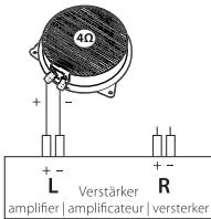
Connection d'un **bassPUMP®** par canal sur un ampli stable à 4 ohm jusqu'à 50 watts rms.
