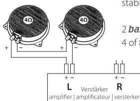
Connection 2 **bassPUMP®** par canal sur un ampli stable à 4 ou 8 ohm jusqu'à 100 watts rms.
