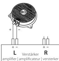
Connection d'un **bassPUMP®** par canal sur un ampli stable à 4–8 ohm jusqu'à 50 watts rms.
