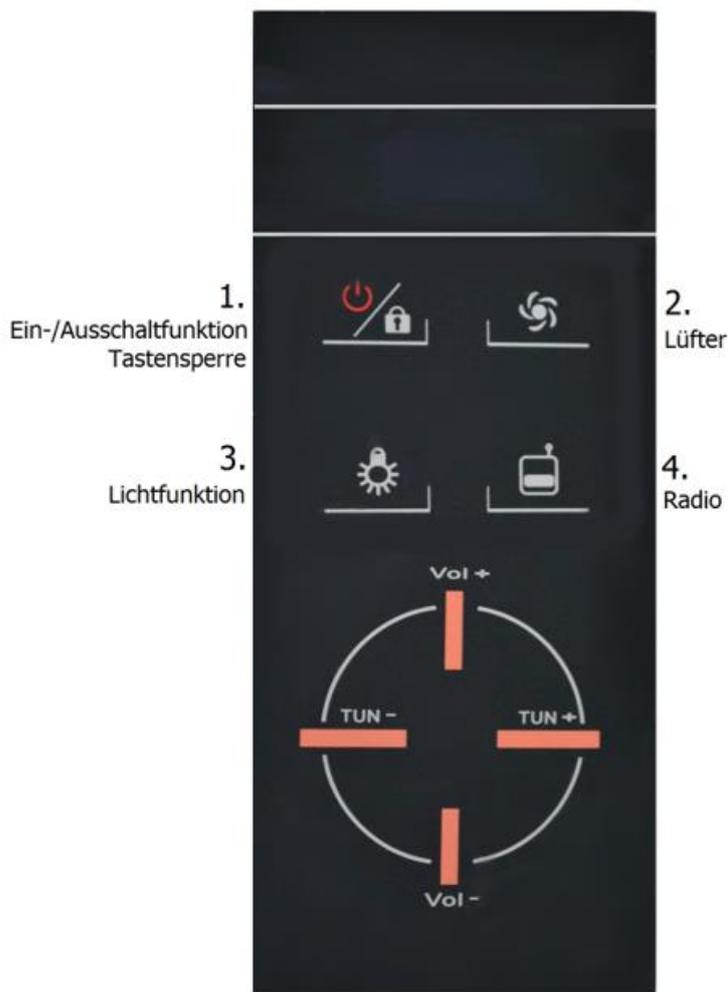
Sender und Volumen werden über die linke und recht, sowie über die oben und unten Tasten eingestellt.
