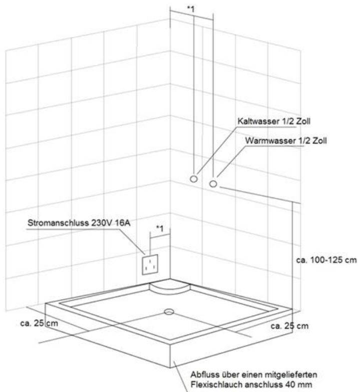
Montieren Sie die Wasseranschlüsse, sowie den Stromanschluss so nah wie möglich in der Mitte.
