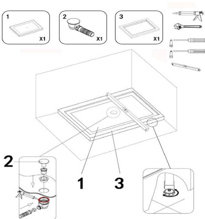
Die Abflüsse des Rahmens müssen mit in den Bodenabfluss eingeführt werden.
