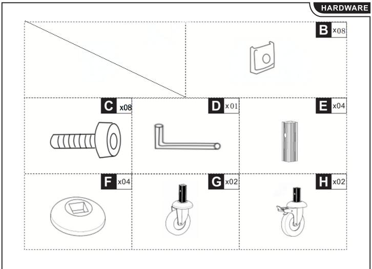
**EN\_**Do not confuse similar screws.Do not tighten bolts fully until all parts are connected! **FR\_**Ne pas confondre des vis similaires.Ne serrez pas les boulons à fond tant que toutes les
