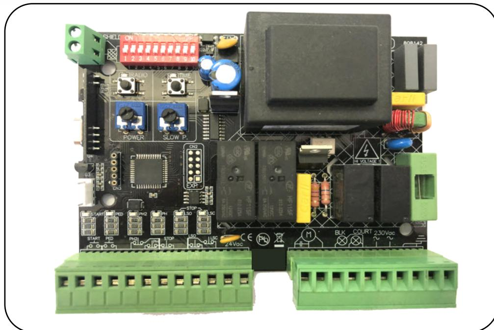
Apparecchiatura di comando 1 Motore 230Vac
