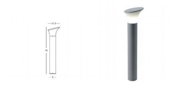
Palo con struttura in pressofusione di alluminio Diffusore in termoplastico satinato Portalampada E27 in porcellana Adatta esclusivamente per lampade a risparmio energetico Altezza max lampade mm 16 Alimentazione 230 V
