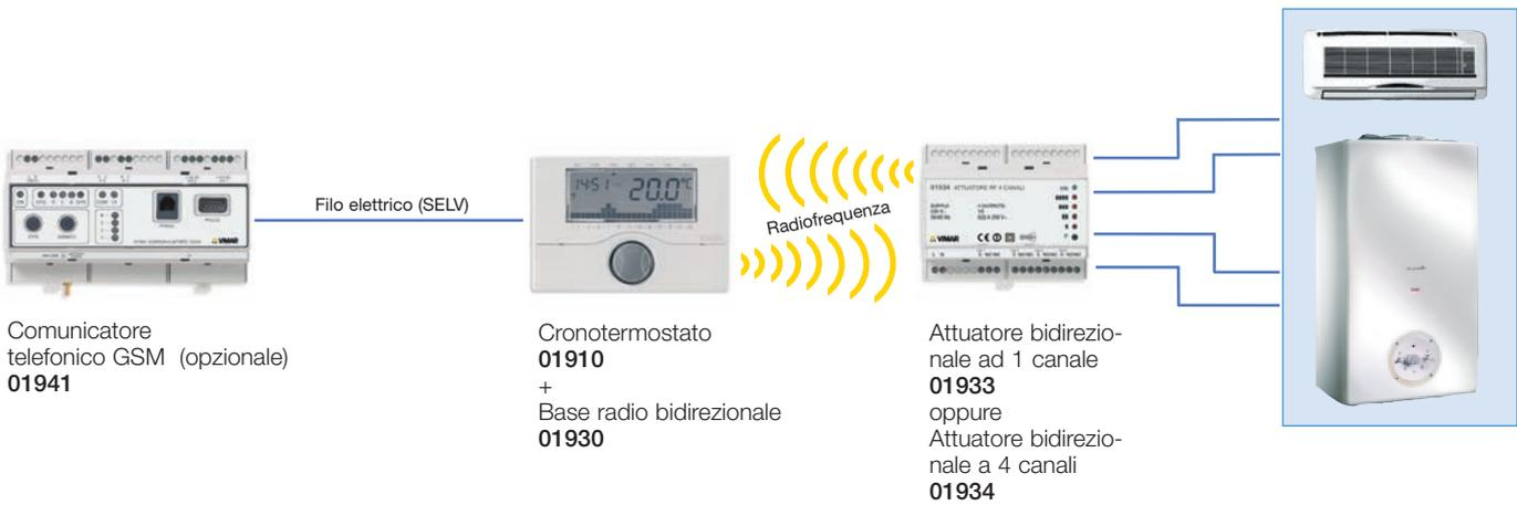
Comandi e controlli in radiofrequenza bidirezionale tra comunicatore GSM e cronotermostato
