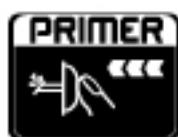
Premere 2/3 volte il bottone del 'Primer' ubicato sotto la leva dello starter fino a quando non si vede il passaggio del carburante all'interno della pompetta trasparente.
