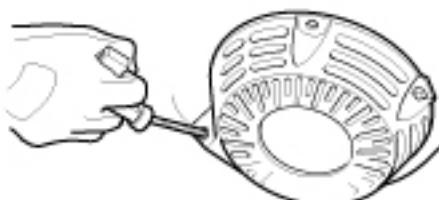
Tirez d'un coup sec sur la corde du démarreur à rupture.
