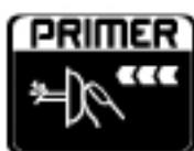
Pulse el botón de "cebado" situado debajo de la palanca del estrangulador 2/3 veces hasta que pueda ver el combustible que pasa por la bomba transparente.
