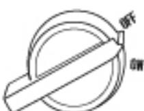
Placez l'interrupteur du démarreur sur le côté du véhicule sur 'ON'.
