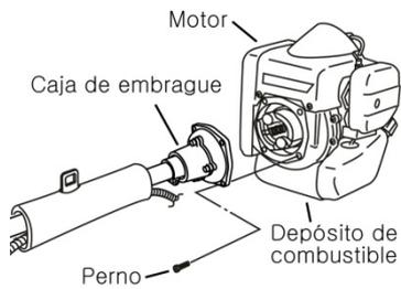
Montar la campana de embrague Utilizando los tornillos insertados.
