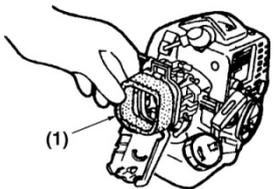
Un filtro de aire atascado reducirá El desempeño del Motor. Verifique periódicamente y limpie El filtro con agua tibia y jabón.
