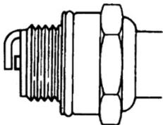
Una bujía sucia o desgastada puede Ocasionar fallos en el arranque. Limpie periódicamente la bujía y Sustitúyala por una nueva.
