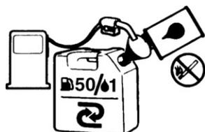
Reposte con gasolina sin plomo y aceite para motores de dos tiempos.
