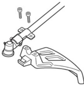
Fijar el protector directamente sobre la caja de transmisión con los tornillos y las tuercas proporcionadas. El tipo de protector que se elige depende del accesorio de corte empleado.
