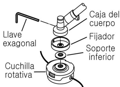
Montaje: Atornillar el cabezal sobre el eje roscado de la caja de transmisión en sentido contrario a las agujas del reloj, mantener el eje bloqueado con la llave o el destornillador a través del agujero de la pequeña tapa anti-enrollamiento del hilo y de la caja de transmisión hasta el bloqueo.
