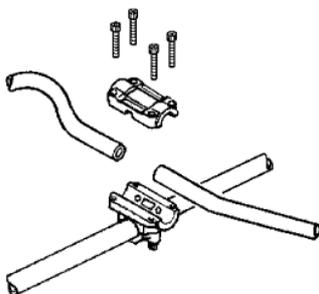
Cojan el medio manillar con la mano derecha y y el otro medio manillar Con la mano izquierda, colocarlos sobre la parte inferior del soporte del colocarlos sobre la parte inferior del soporte del manillar y bloquearlos con la tapa por medio de los tornillos.
