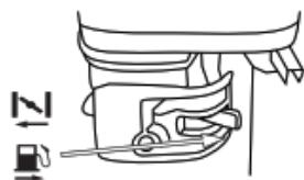
A. Impostare l'interruttore del motore in posizione ON.
