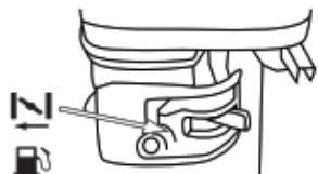
B. Mova a alavanca do passo de gás para a posição ON.
