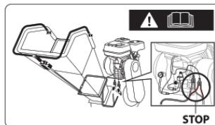
Avvertimento! Arresto di emergenza. Assicurarsi che il cavo sia collegato correttamente
