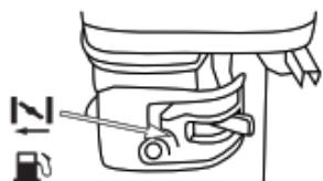
B. Mueva la palanca del paso de la gasolina a la posición ON.
