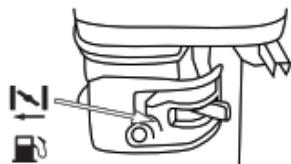
B. Spostare la leva del passo del gas in posizione ON.
