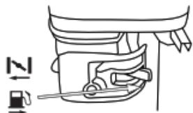
A. Coloque el interruptor del motor en la posición ON.
