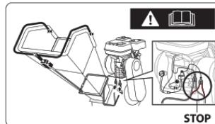
Atenção! Paragem de emergência. Verifique se o cabo está conectado corretamente
