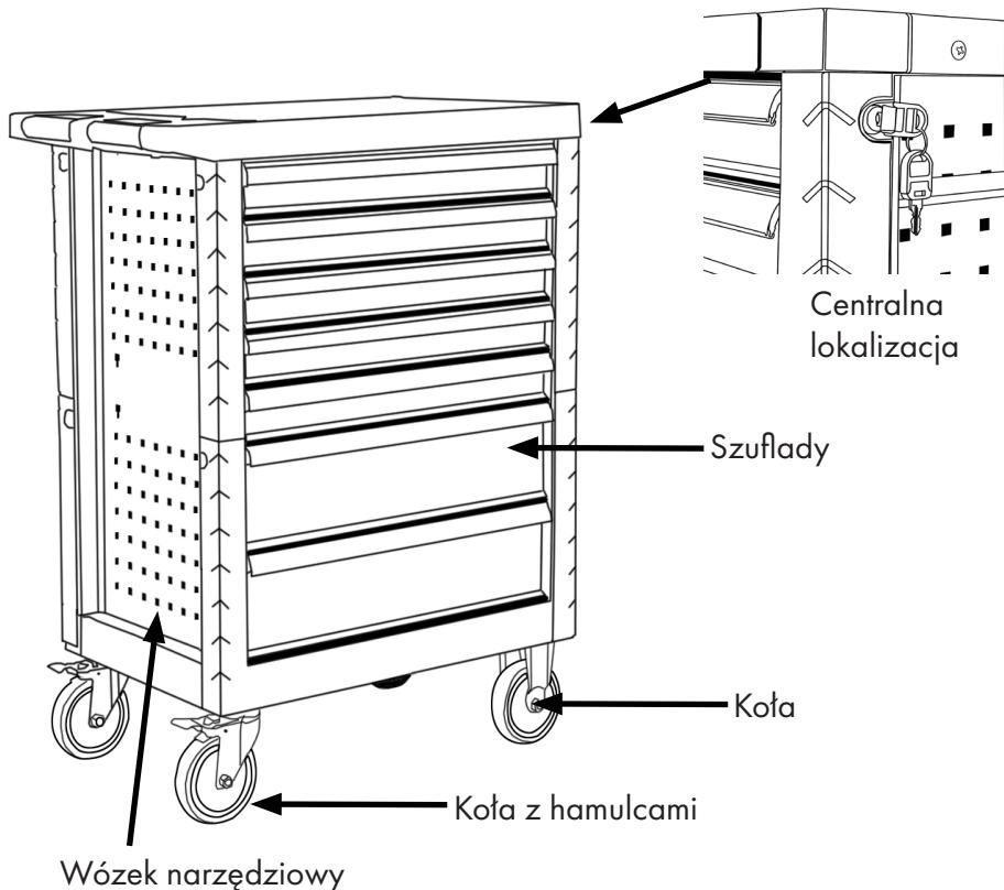
**Elementy wózka narzędziowego****Rys. 1**
