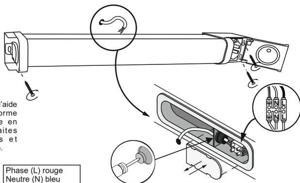
Retirer le cache, puis à l'aide d'un tournevis cruciforme trouer le passe câble en caoutchouc noir. Faites passer les câbles et connectez les au domino.
