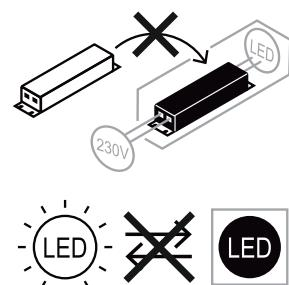
**FR** - Les composants du projecteur sont intégrés et ne sont pas remplaçable et le produit ne doit être ouvert.
