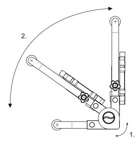
FR. 1. Desserrez les deux cotés de la structure 2. Maintenez le pied et ajuster la position du projecteur puis resserrez les deux cotés
