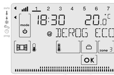
**Les appareils de chauffage qui sont passés en Éco, sont ceux dont les récepteurs radio bidirectionnel appartient à la zone sélectionnée.**
