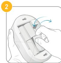
Retirez le capot arrière et remplacez les piles (4x 1,5 V alcalines D).
