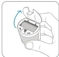
Ouvrez le couvercle et remplacez la pile (IntelliTAG® : 1x 1,5 V alcaline AAA / Détecteur de mouvement : 1x 1,5 V Lithium CR123A).
