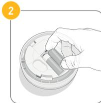
Ouvrez le clavier et remplacez les piles (2x 1,5 V alcalines AA).
