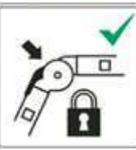
Stellen Sie vor Besteigen der Leiter sicher, dass die Feststellvorrichtung auch korrekt verriegelt ist.
