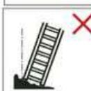
Nutzen Sie die Leiter nicht auf unebenen oder weichem Untergrund. Stellen Sie die Leiter nicht auf verunreinigten Boden. (Flüssigkeiten wie z.B. Öl oder Wasser können den Halt beeinträchtigen) Benutzen Sie die Leiter nicht im verschmutzten Zustand, z.B. bei Verunreinigungen mit frischer Farbe, Schlamm, Öl oder Schnee.
