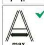
Öffnen Sie die Leiter vollständig vor der Verwendung. Achten Sie darauf, dass die Feststellvorrichtungen dabei auch greifen und stabil sind.
