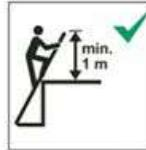
Leitern, die als Zugang zu einer erhöhten Ebene genutzt werden, sollen stets mindestens 1m über den Ausstiegspunkt hinaus ragen und, wo nötig, gesichert werden.
