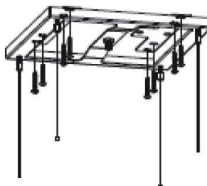
7. Fissare i 4 cavi metallici alla copertura e usare il dado di bloccaggio per fissare la copertura al pannello di sospensione. (v. immagine 5). Tenere presente che il foro per il cavo di alimentazione sul pannello di copertura deve essere nella stessa direzione del foro per il cavo di alimentazione sulla cappa aspirante.
