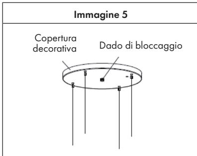
8. Seguire i passaggi 1 e 2 dell'immagine 6 per inserire i 4 cavi metallici nella fessura del pannello superiore della cappa aspirante e utilizzare quattro viti a testa svasata (ST4\*8 mm) per fissare i cavi ed evitare che scivolino di nuovo fuori (v. immagine 6).
