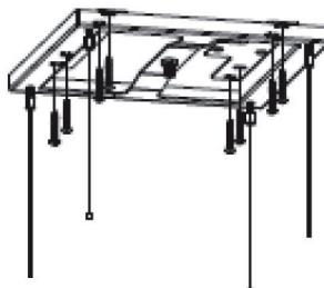
7. Fije los 4 cables a la cubierta y utilice la tuerca de seguridad para fijar la cubierta a la tabla de suspensión. (Véase la imagen 5) Tenga en cuenta que el orificio para el cable de alimentación en la placa de cubierta debe estar en la misma dirección que el orificio para el cable de alimentación en el capó de la cocina.
