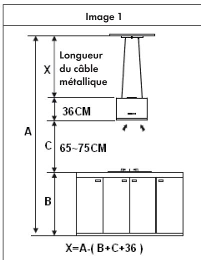
3. Le plafond doit pouvoir supporter un poids d'au moins 120 kg et son épaisseur doit être  $\geq 30$  mm.
