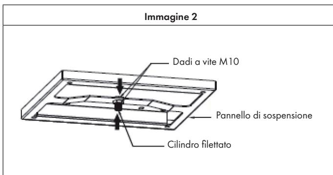
5. Fissare le 4 viti regolabili al pannello di sospensione, ruotarle alla lunghezza giusta e senza stringere troppo. L'altezza delle 4 viti è praticamente la stessa. Far passare i 4 cavi metallici attraverso le 4 viti regolabili, calcolare la lunghezza del cavo secondo la figura 1 e segnare la lunghezza sul cavo stesso. Utilizzare le 4 viti di bloccaggio dei cavi + i dadi per fissarli nei punti segnati. Assicuratevi che i 4 cavi metallici siano della stessa lunghezza (v. foto 3).
