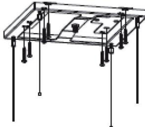
7. Befestigen Sie die 4 Drahtseile an der Abdeckung, und verwenden Sie die Sicherungsmutter, um die Abdeckung am Aufhängebrett zu befestigen. (Siehe Bild 5). Beachten Sie, dass das Loch für das Stromkabel auf der Abdeckplatte in der gleichen Richtung wie das Loch für das Stromkabel auf der Dunstabzugshaube sein sollte.
