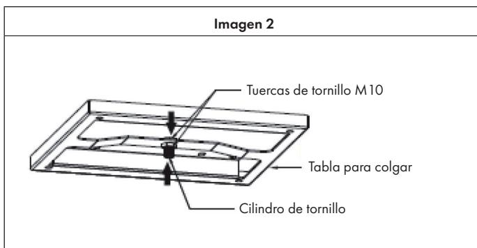
5. Fije los 4 tornillos ajustables a la tabla para colgar, gírelos a la longitud correcta y no demasiado apretados. La altura de los 4 tornillos es básicamente la misma. Pase los 4 cables de acero por los 4 tornillos ajustables, calcule la longitud del cable de acero según la imagen 1 y marque la longitud en el cable. Utilice los 4 tornillos de sujeción de la cuerda + tuercas para fijar las 4 cuerdas en los puntos marcados. Asegúrese de que las 4 cuerdas tienen la misma longitud (ver imagen 3).
