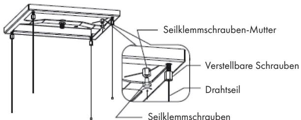
6. Bohren Sie 8 Montagelöcher an der Decke entsprechend den 8 runden Löchern auf dem Aufhängebrett und befestigen Sie das Aufhängebrett mit 8 Senkkopfschrauben (ST6\*40 mm) an der Holzdecke (siehe Bild 4). Wenn die Decke aus Beton besteht, müssen Sie entsprechend den 4 Löchern auf dem Hängebrett 4 Montagelöcher bohren und vier Senkkopfschrauben ( $\varnothing 6 * 60$ ) verwenden, um das Hängebrett an der Decke zu befestigen.
