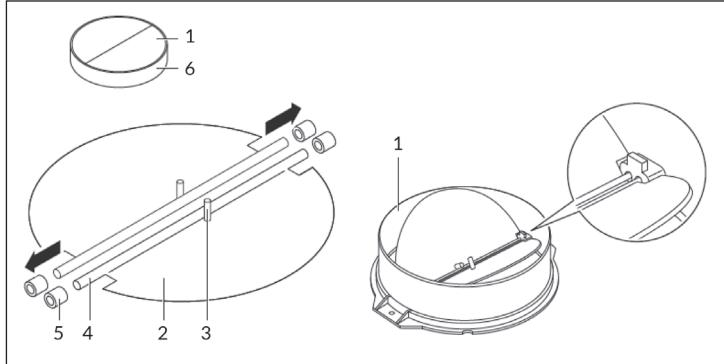
Si vous disposez d'une sortie d'air vers l'extérieur, la hotte aspirante raccordez la hotte avec un conduit d'extraction (émail, aluminium, tuyau flexible ou matériau incombustible d'un diamètre intérieur de 150 mm) comme illustré sur la droite.
