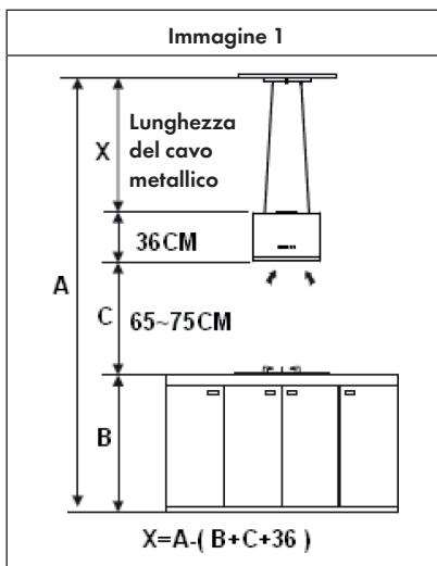
3. Il soffitto deve essere in grado di sostenere un peso di almeno 120 kg e il suo spessore deve essere  $\geq 30$  mm.
