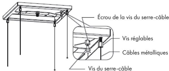
6. Percez 8 trous de fixation au plafond correspondant aux 8 trous ronds du panneau d'accrochage et fixez le panneau d'accrochage au plafond en bois à l'aide de 8 vis à tête fraisée (ST6 \* 40 mm) (voir photo 4). Si le plafond est en béton, vous devez percer 4 trous de fixation correspondant aux 4 trous du panneau suspendu et utiliser quatre vis à tête fraisée ( $\text{Ø}6 * 60$ ) pour fixer le panneau d'accrochage au plafond.
