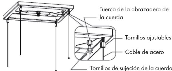
6. Taladre 8 agujeros de montaje en el techo que correspondan a los 8 agujeros redondos para la tabla y fijela al techo de madera con 8 tornillos avellanados (ST6 \* 40 mm) (véase la imagen 4). Si el techo es de hormigón, deberá realizar 4 agujeros de montaje correspondientes a los 4 agujeros de la tabla de colgar y utilizar cuatro tornillos avellanados ( $\varnothing 6 * 60$ ) para fijar la tabla al techo.
