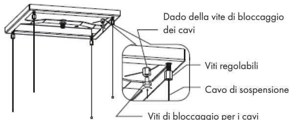
6. Praticare 8 fori di montaggio sul soffitto in corrispondenza degli 8 fori rotondi sul pannello di sospensione e fissare il pannello al soffitto di legno con 8 viti a testa svasata (ST6\* 40 mm) (v. figura 4). Se il soffitto è in cemento, è necessario praticare 4 fori di montaggio in corrispondenza dei 4 fori sul pannello di sospensione e utilizzare quattro viti a testa svasata( $\varnothing 6*60$ ) per fissare il pannello al soffitto.
