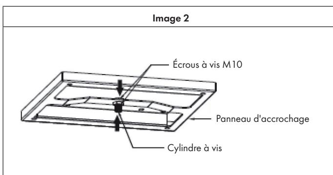
5. Fixez les 4 vis réglables sur le panneau d'accrochage, en les tournant à la bonne longueur et sans trop les serrer. La hauteur des 4 vis est en principe la même. Passez les 4 câbles métalliques à travers les 4 vis réglables, calculez la longueur du câble métallique selon l'image 1 et marquez la longueur sur le câble. Utilisez les 4 vis du serre-câble + écrous pour fixer les 4 cordes aux points marqués. Veillez à ce que les 4 cordes soient de même longueur (cf. image 3).
