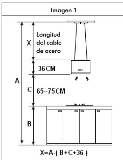
3. El techo debe ser capaz de soportar un peso de al menos 120 kg y el grosor del techo debe ser  $\geq 30$  mm.
