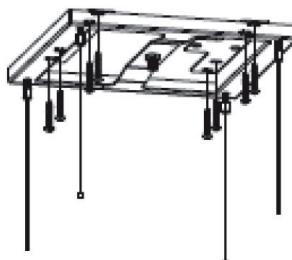
7. Fixez les 4 câbles métalliques au couvercle et utilisez l'écrou de blocage pour fixer le couvercle au panneau d'accrochage. Cf. image 5. Notez que le trou pour le câble d'alimentation sur la plaque de recouvrement doit se trouver dans la même direction que le trou pour le câble d'alimentation sur la hotte.
