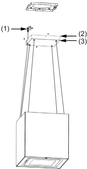
Nachdem Sie die Abzugshaube angebracht haben, kann es sein, dass Sie sie noch etwas ausbalancieren müssen. Dazu brauchen Sie eine zweite Person, die die Haube leicht anhebt, während Sie die Haube über die einstellbaren Verschlüsse (1) oben an den Drahtseilen (2) ausbalancieren.
