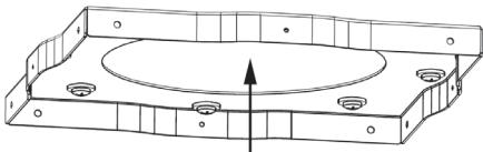
Orificio para la conexión eléctrica
