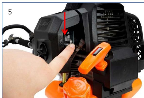
5. **NB** : Dès que le moteur a répondu, mettez le levier du starter en position "WARM START" et tirez immédiatement sur le lanceur jusqu'à ce que le moteur démarre. "voir aussi le démarrage du dispositif en vidéo sur notre page d'accueil".
