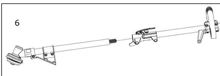
**7. Montage de l'arbre de transmission flexible (4) sur la cloche d'embrayage (5)**
