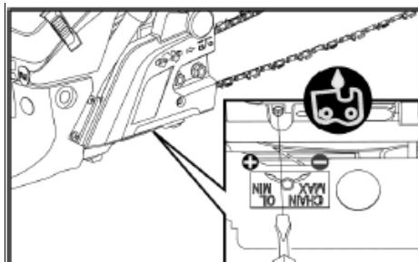
O parafuso de regulação do doseamento de óleo encontra-se na parte inferior da motosserra.
