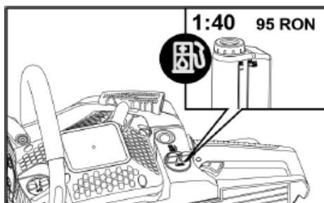
Bränslet som används till den luftkylda 2-takts bensinmotorn är en blandning av 2-takts bensin och olja med en antioxidanttillsats för 2-taktsmotorer.
