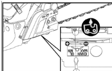
De stelschroef voor de oliedosering bevindt zich aan de onderkant van de kettingzaag. Op een label dat hierop is bevestigd, staat beschreven hoe de oliestroom kan worden verhoogd of verlaagd om de zaagketting te smeren.
