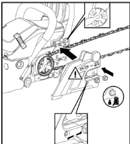
**Vuelva a colocar el protector de cadena en la unidad de transmisión (A). Para este propósito:**
