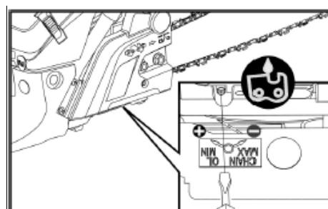
Die Einstellschraube für die Öldosierung ist am Unterboden der Kettenäge angeordnet. Ein dort befestigtes Schild beschreibt das Erhöhen oder Verringern des Ölzuflusses zum Schmieren der Sägekette.
