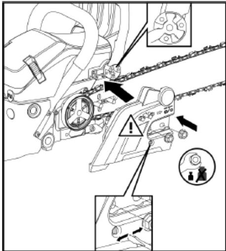
**Ponownie zamontować osłonę łańcucha na jednostce napędowej (A). W tym celu:**
