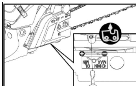
Justeringsskruven för oljedosering sitter på undersidan av motorsågen.
