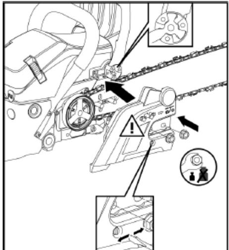
**Voltar a colocar a cobertura da corrente na unidade de tração (A). Para o efeito:**
