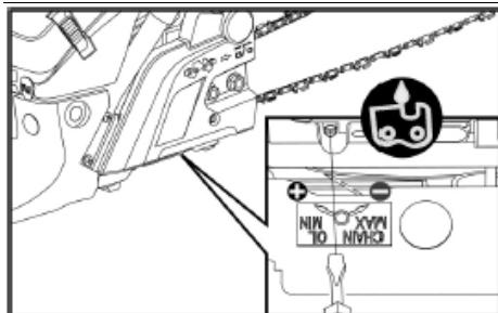
La vis de réglage pour le dosage de l'huile se situe au-dessous de la tronçonneuse. Une plaque fixée à cet endroit décrit l'augmentation ou la diminution de l'arrivée d'huile pour lubrifier la chaîne de scie.
