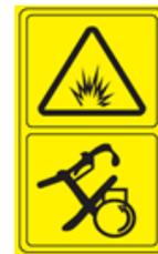
Le carburant est inflammable. Tenez la machine à l'écart des flammes nues ; Ne faites pas le plein du réservoir lorsque le moteur est en marche.
