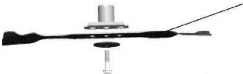
Remettez tout en place comme indiqué. Fixez la vis correctement. Le couple de fixation est de 45 Nm. Remplacez également la vis de la lame lorsque vous remplacez la lame.
