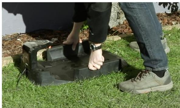
Die Ladestation muss auf einer festen, ebenen Fläche platziert werden, wobei der Pfeil "IN" auf der Ladestation in Richtung des Arbeitsbereichs zeigen muss.
