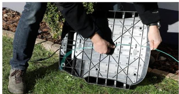
Nadat u de twee uiteinden (IN en OUT) hebt aangesloten, plaatst u de beschermkap erop
