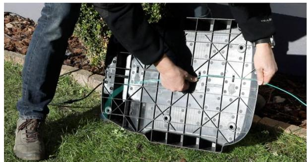
Efter att ha anslutit de två ändarna (IN och OUT), sätt på skyddsskåpan
