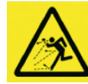
Durante a operação, os objetos podem ser jogados para longe do cortador. Mantenha uma distância segura da máquina durante a operação. Cuidado.
