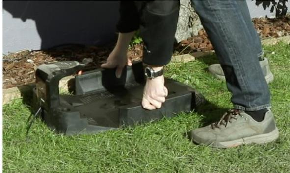
La station de recharge doit être placée sur une surface stable et plane, la flèche "IN" de la station de recharge étant orientée vers la zone de travail.
