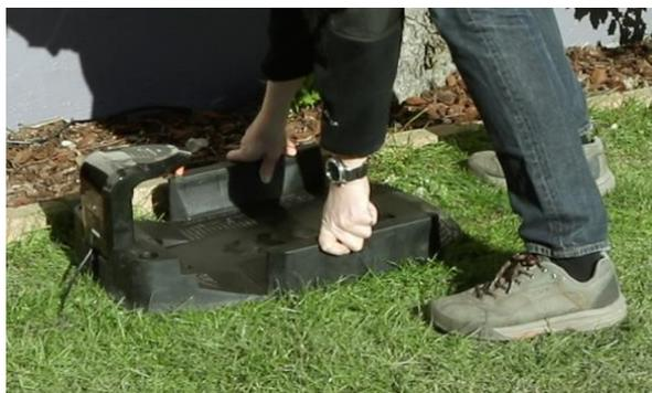
Stacja ładująca musi być umieszczona na stabilnej, płaskiej powierzchni, ze strzałką "IN" na stacji ładującej skierowaną w stronę obszaru roboczego.
