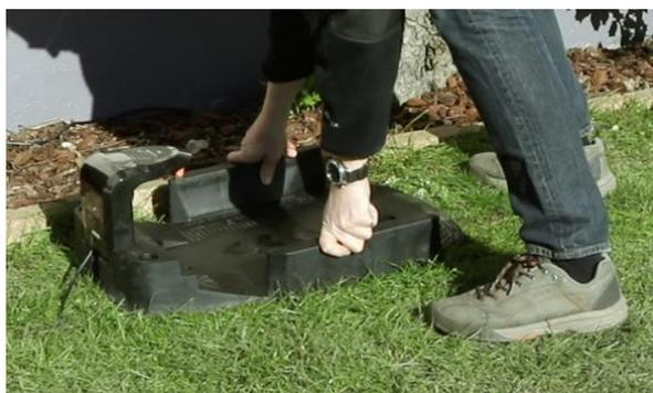
La estación de carga debe colocarse sobre una superficie firme y plana, con la flecha "IN" de la estación de carga apuntando hacia el área de trabajo.
