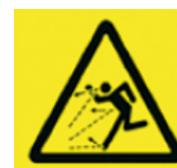
Under drift kan föremål kastas bort från gräsklipparen. Håll ett säkert avstånd från maskinen under drift. Var försiktig.
