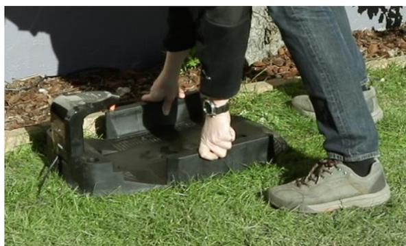
Het laadstation moet op een stevige, vlakke ondergrond worden geplaatst, met de "IN"-pijl op het laadstation in de richting van het werkgebied.
