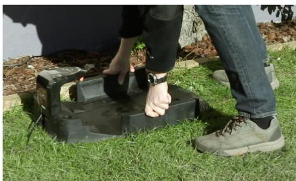
A estação de carregamento deve ser colocada numa superfície firme e plana, com a seta "IN" na estação de carregamento apontada para a área de trabalho.
