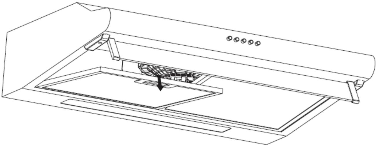
3. Lampe durch Drehung nach links herausdrehen.
