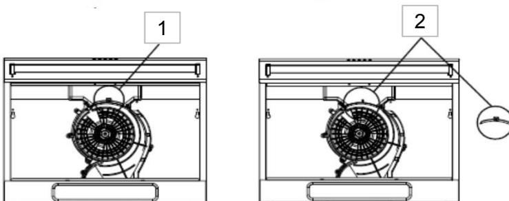
Für Abluftbetrieb den Modus-Auswahlblock (**Abb. 1**) nicht entfernen.
