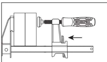
③ Drücken Sie den Schnellauslöser und schieben Sie die Klemme entlang der Stange nach vorne, um das Werkstück einzuklemmen.
