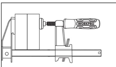
④ Rotare la maniglia in senso orario per assicurarsi che il pezzo sia saldamente fissato.
