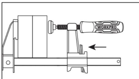
③ Presione el gatillo de liberación rápida y deslice hacia delante a lo largo de la barra para sujetar la pieza de trabajo.
