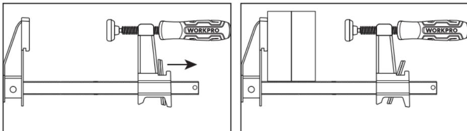
① Appuyez sur la gâchette à déclenchement rapide et reculez jusqu'à la largeur nécessaire, puis relâchez la gâchette.
