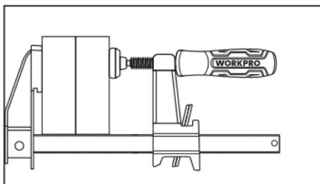
④ Gire el mango en el sentido de las agujas del reloj para asegurarse de que la pieza de trabajo está firmemente sujetada.
