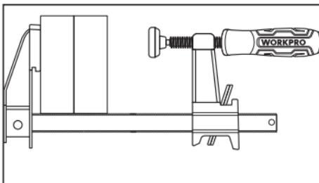
② Insérer la pièce dans les mâchoires ouvertes du serre-joint.
