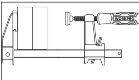
② Führen Sie das Werkstück in die offenen Backen der Klemme ein.
