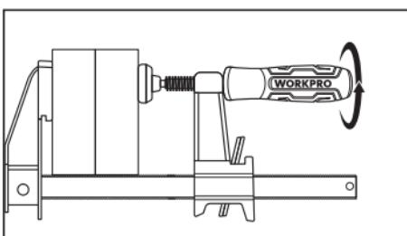
④ Drehen Sie den Griff im Uhrzeigersinn, um sicherzustellen, dass das Werkstück sicher befestigt ist.
