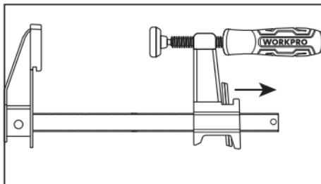
① Presione el gatillo de liberación rápida y mueva hacia atrás hasta la anchura necesaria y luego suelte el gatillo.
