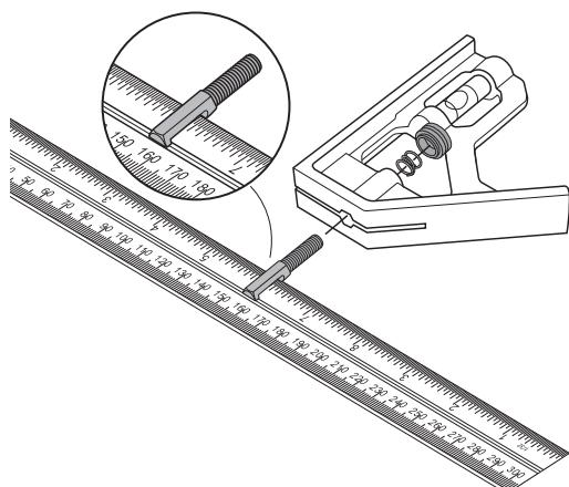
L'équerre comprend une règle graduée en acier trempé et une équerre mobile avec un niveau à bulle et une règle à tracer. Avec un niveau à bulle et une règle à tracer, elle possède une face carrée de 90° et une face à onglet de 45°, toutes deux rectifiées avec précision. C'est un outil de traçage très polyvalent pour tracer des angles droits et des lignes parallèles, et un outil de mesure qui peut être utilisé comme équerre, onglet, jauge de profondeur, jauge de hauteur et niveau.
