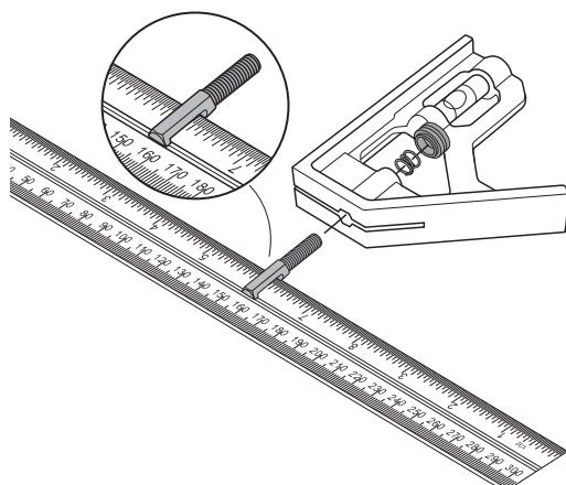
La escuadra combinada incluye una regla graduada de acero endurecido y una escuadra combinada móvil con nivel de burbuja y pin de marcado, tiene una cara cuadrada de 90° rectificada con precisión y una cara de inglete de 45°. Es una herramienta de diseño muy versátil para trazar ángulos rectos y líneas paralelas, y una herramienta de medición que se puede utilizar como escuadra triple, inglete, calibrador de profundidad, calibrador de altura y nivel.
