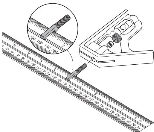
Der Kombinationswinkel umfasst einen Maßstab aus gehärtetem Stahl und einen beweglichen Kombinationswinkel mit Wasserwaage und Reißnadel. Er hat eine präzisionsgeschliffene 90°-Winkelfläche und eine 45°-Gehrungsfäche.
