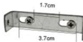
Percez des trous dans le mur en fonction de la distance entre les trous de fixation.
