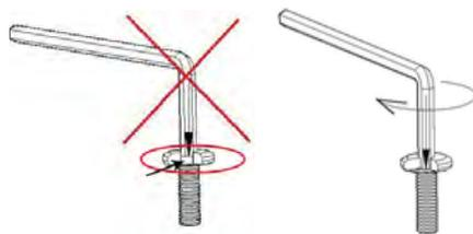
Si vous ne le faites pas et que vous glissez hors de l'échancrure, ça engendrera des dommages sur la vis, lesquelles peuvent conduire à fausser l'intérieur la tête de vis, ce qui aura pour conséquence d'empêcher toute prise avec la clé Allen. Les têtes de vis faussées ne sont que le résultat de cette mauvaise manipulation et ne sont pas un objet de réclamation.
