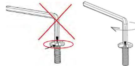
Wenn Sie dies nicht tun und aus der Schraube abrutschen, wird die Schraube Schaden nehmen und es kann dazu kommen, dass der Schraubenkopf innenseitig rund wird und Sie mit dem Sechskantschlüssel keinen Halt mehr finden. Rund gedrehte Schraubenköpfe resultieren nur hieraus und sind kein Grund für eine Reklamation.
