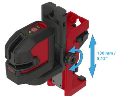
Ruotare la monopola di regolazione micrometrica dello UAL130 per regolare con precisione la linea orizzontale rispetto al livello di riferimento desiderato.
