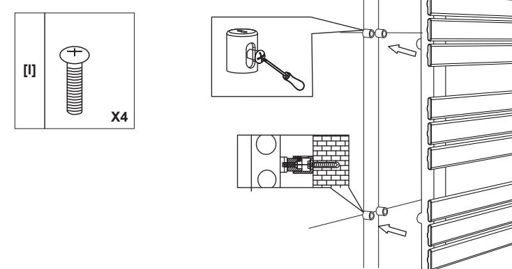
**Schritt 5:** Installieren Sie den Thermostat auf dem Handtuchhalter.
