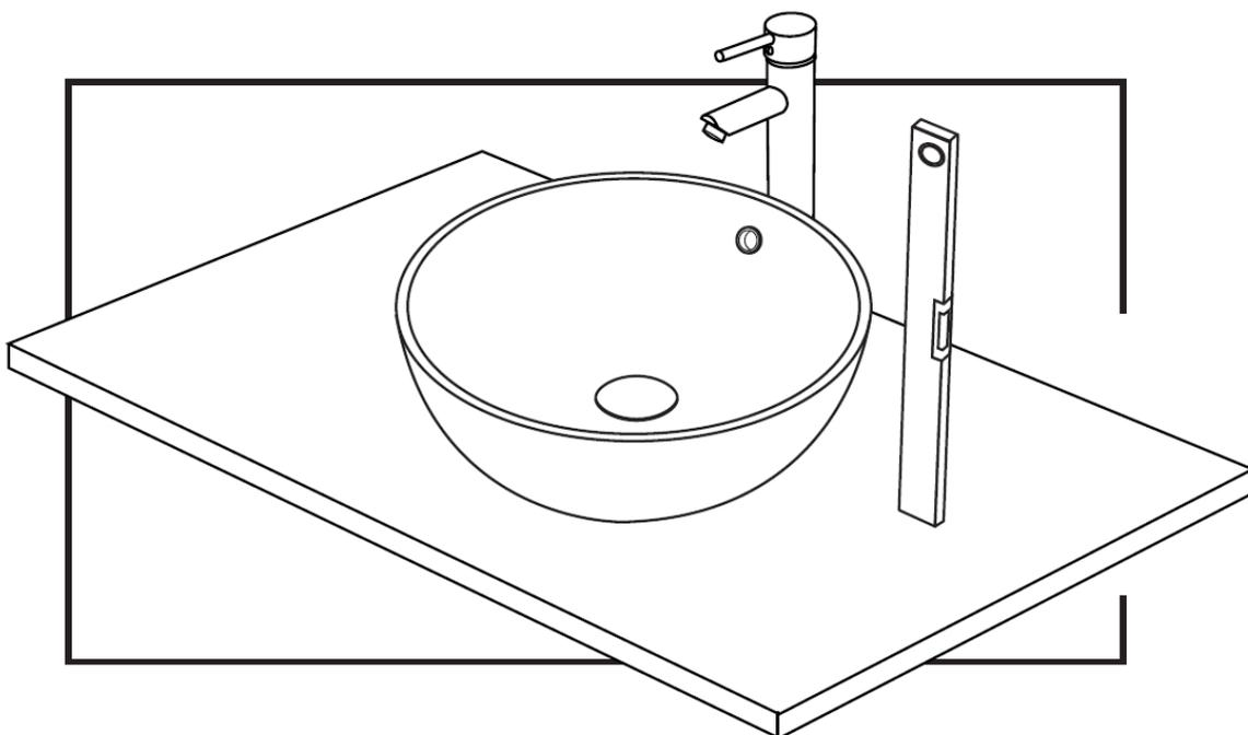
3. À l'aide d'un crayon, marquez un trou sur le plan de travail pour permettre l'installation d'un raccordement l'évacuation avec siphon.
