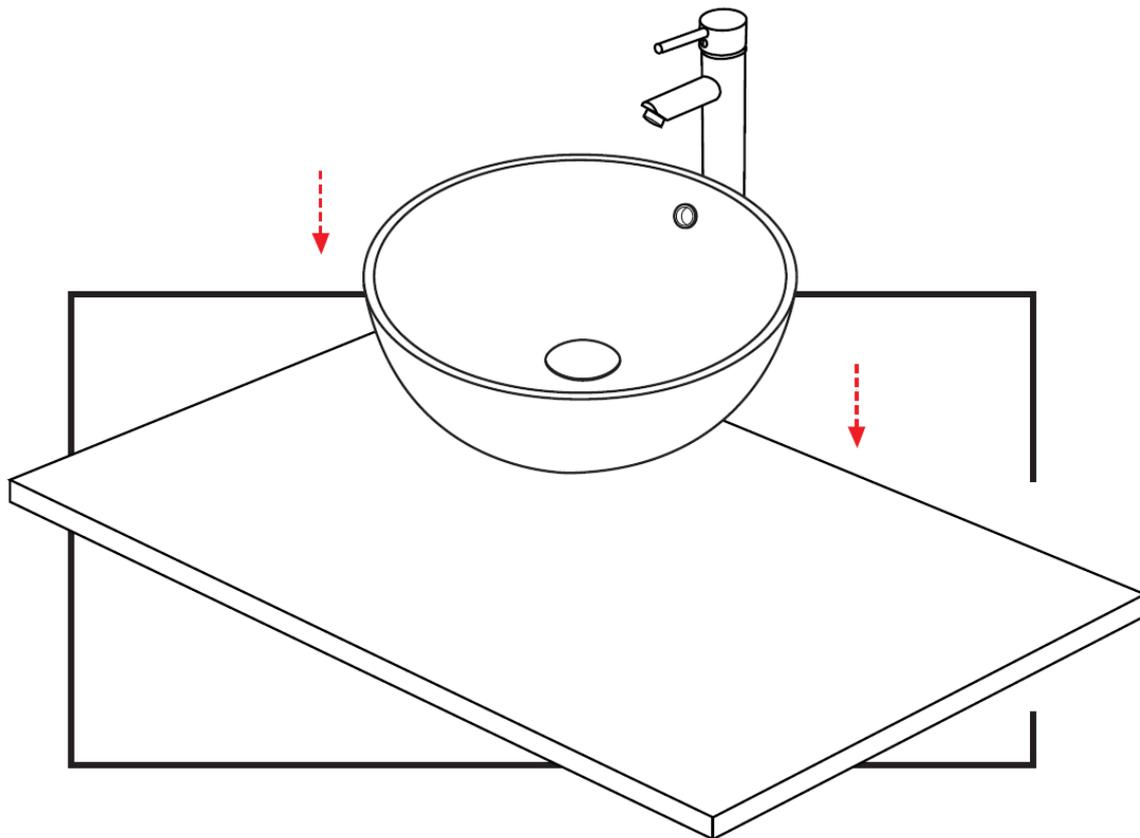
2. Überprüfen Sie die Stabilität auf dem Schrank oder der Arbeitsplatte und die Nivellierung des Waschbeckens.
