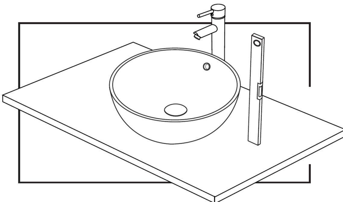
3. Markieren Sie mit einem Bleistift ein Loch auf der Arbeitsplatte für den Ablaufanschluss mit dem Siphon.
