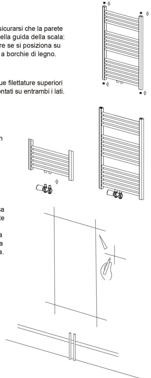
5. Montaggio su parete in mattoni o brise Praticare il foro con una punta da muratore da 8 mm nelle posizioni di montaggio desiderate e inserire il tassello E nel foro in modo che sia a filo con la parete.
