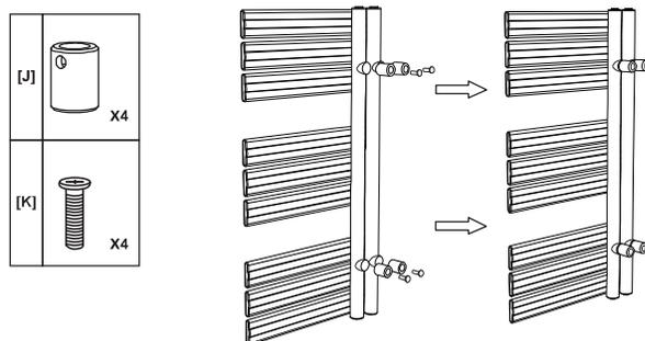
**Étape 4:** Fixez le radiateur au mur et serrez les petites vis I dans les supports.
