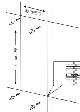
Markieren Sie die Position der Schrauben an der Wand, bohren Sie vier entsprechende Löcher und schlagen Sie die Nummer G in die Wand.
