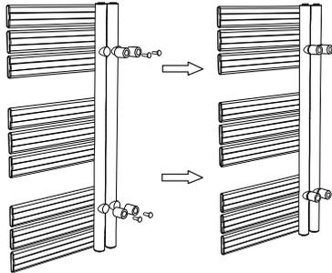
**Schritt 4:** Befestigen Sie den Heizkörper an der Wand und ziehen Sie die kleinen Schrauben I in den Halterungen fest.
