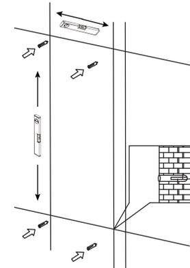
Marquez la position des vis sur le mur, puis percez quatre trous en conséquence et tapez le numéro G sur le mur.
