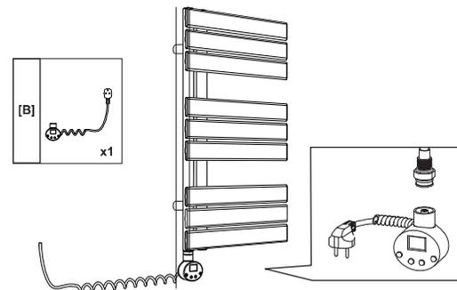
1. Asegúrese de que los pasadores de la varilla de calefacción se alinean con el orificio de la unidad del termostato y, a continuación, inserte los pasadores de forma segura
