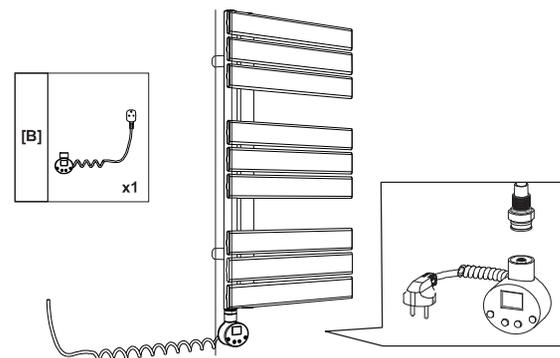
1. Assicurarsi che i perni dell'asta di riscaldamento siano allineati con il foro sull'unità termostatica, quindi inserire saldamente i perni.
