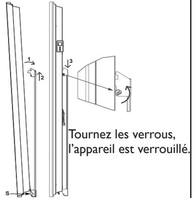
**4 5** - Posez l'appareil sur le support S selon les schémas.
