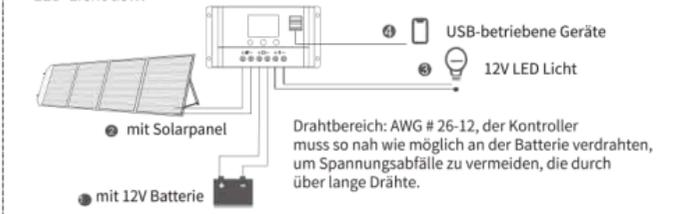
\* Ein geeigneter Controller/Regler (Empfohlene ALLPOWERS PWM 20/30A Solarregler) muss zwischen dem Solarpanel und Ihrer Batterie platziert werden, schließen Sie alle an Komponenten gemäß den Anweisungen des Controller/Regler.
