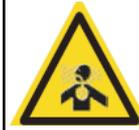
Non utilizzare mai l'inverter in un'area chiusa. Lo scarico del motore contiene monossido di carbonio. Azionare l'inverter solo all'esterno e lontano da finestre, porte e prese d'aria.
